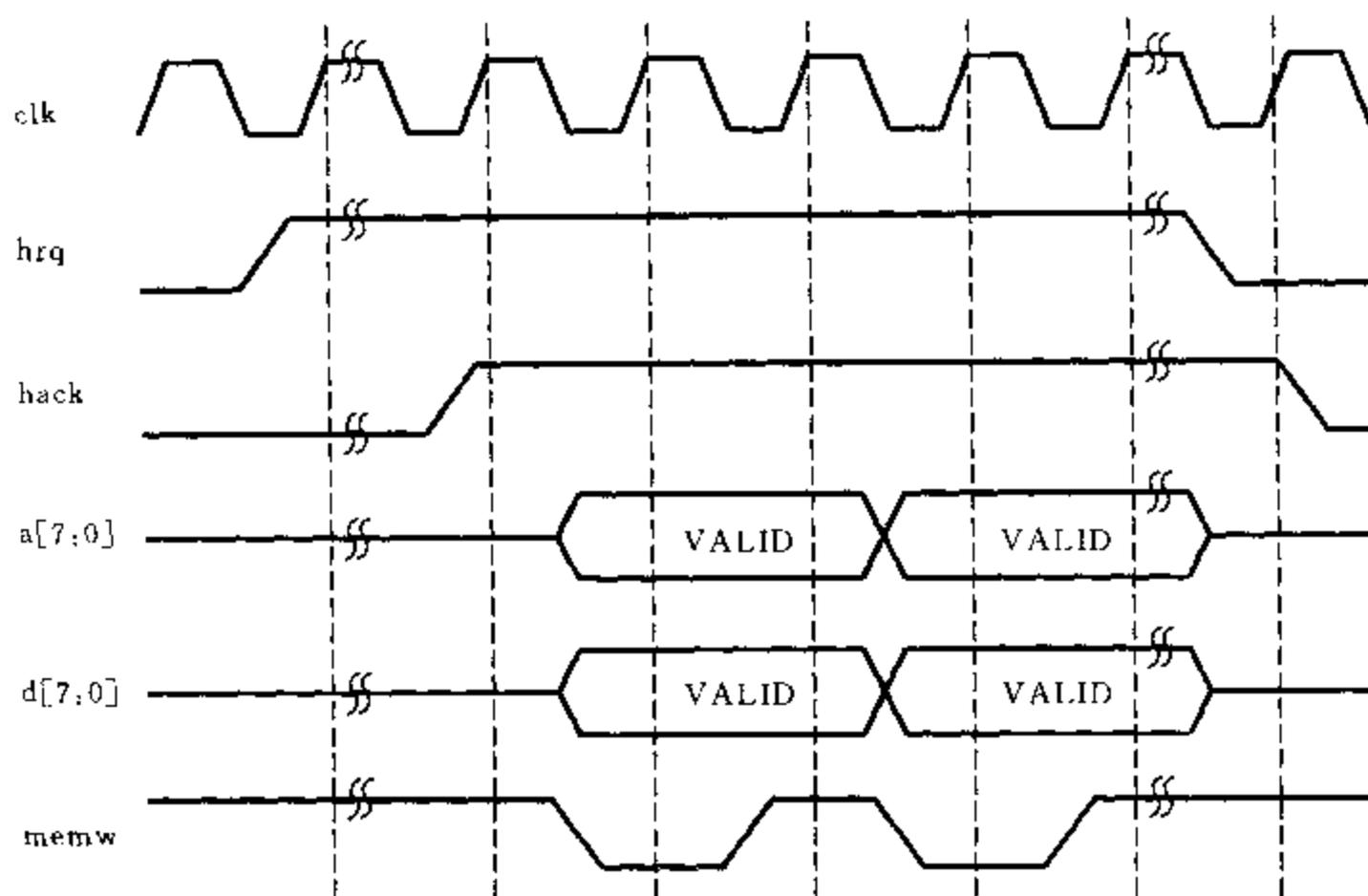
图 10.4 存储器总线的时序图
