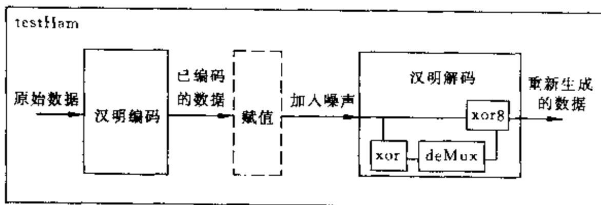
图 4.3 带噪声沟道的汉明编码和译码器
