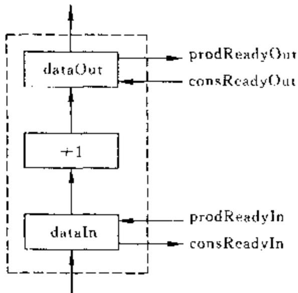
个循环中永不停止地流动,每次循环时数据都加 1。加上附加代码是为了执行时对模型进行初始化。
