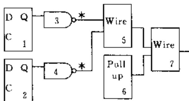
图 9.6 驱动线的两个集电极开路门
