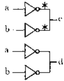
在此说明了一般的连线类型和线与线网类型的差异。d 被声明为一个连线型线网，c 被声明为线与类型的线网，c 和 d 都被两个不同的非门驱动。声明为线与类型的线网实现线与功能。当两个输入 a 和 b 均为 0 时输出 c 为 1。
