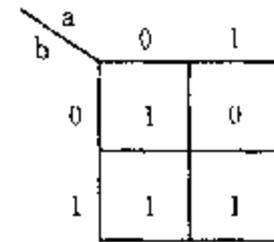
第一个 case 项说明如果 a 为 0,那么输出 f 为 1。语句中? 的使用表示在这种情况下 b 的值无关紧要。请注意这个函数不包含无关项。而且,我们使用? 这种方式来说明函数显得更加简单和紧凑。因为第一个 case 项包括了四种可能情况中的两种,所以它与其他两个 case 项一起构成了一个完整的 casex。在本例中,用? 来指明逻辑无关项。也可以使用 x 或 z。
