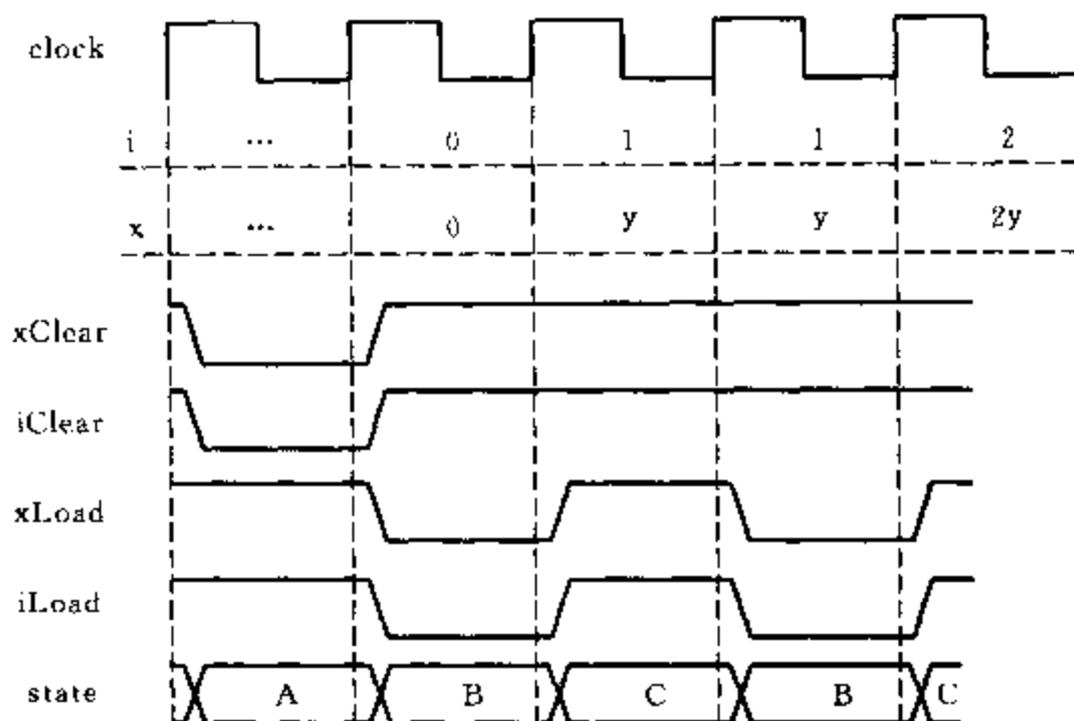
图 1.11 状态 A、B、C 的时序图
