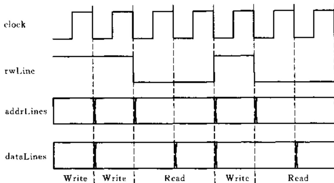
图 3.2 同步总线协议
