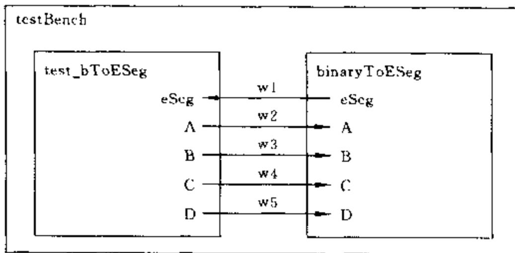
图 1.3 设计模块和测试模块的互连
