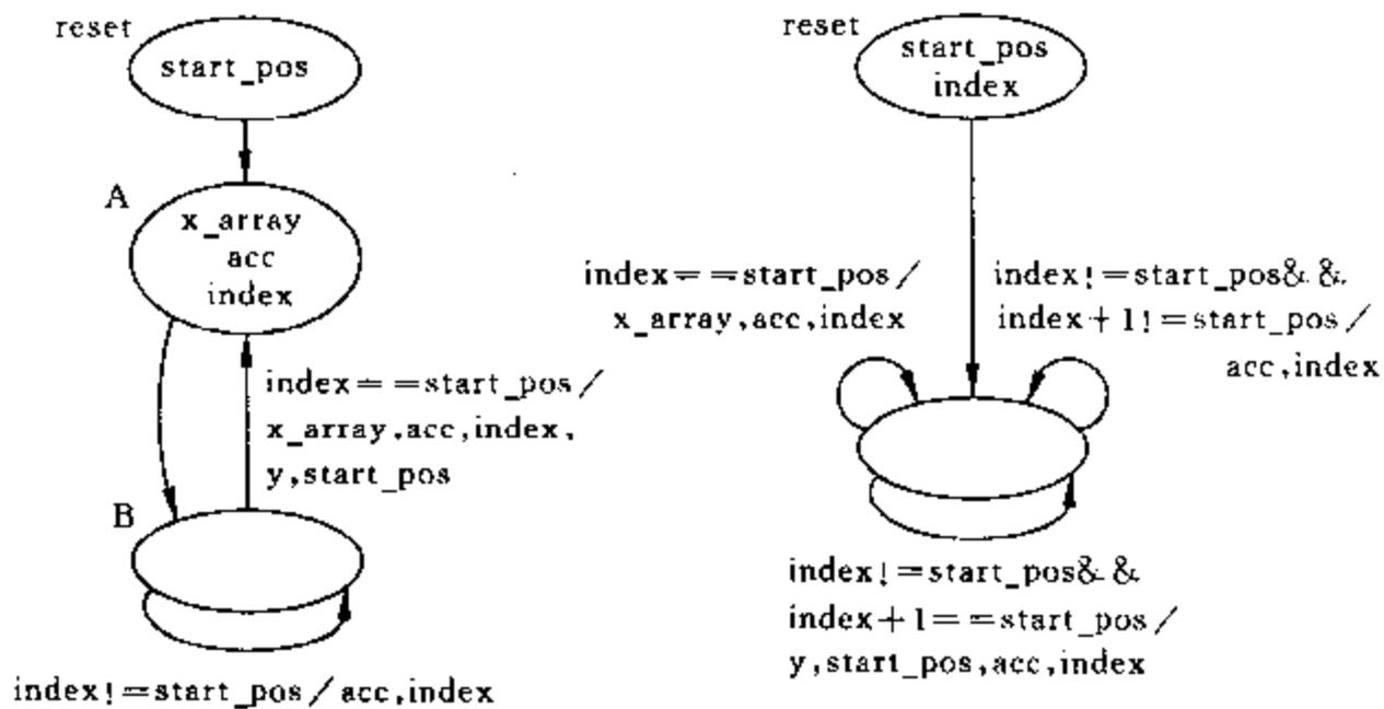
图 7.3 例 7.5(左侧)和例 7.6(右侧)的状态转换图
