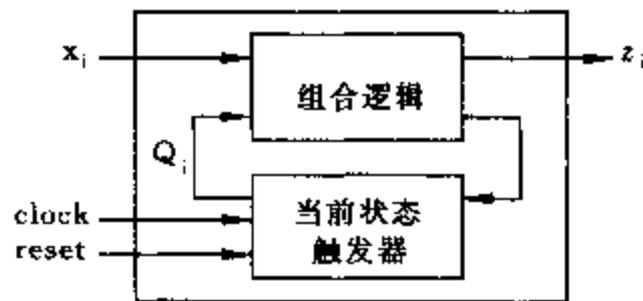
图 6.1 有限状态机的标准模型
