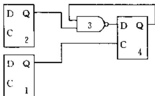
图 9.5 触发电路
