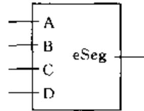
第一行是模块定义语句,模块端口显示在括号内。模块内这些端口必须说明为 inputs, outputs 或双向的 inout。注意输出端口不一定要出现在第一位,通常基本的与非门就是这种情况。在第二行,说明 eSeg 是一个输出端口。在第三行,说明 4 个输入端口名称为 A、B、C、D。与例 1.2 相比, A、B、C、D 现在是连接输入端口和门的连线。binaryToESeg 模块的逻辑图如示例右边所示。注意逻辑图中所示模块内部的端口名称,它们仅在模块内部已知。
