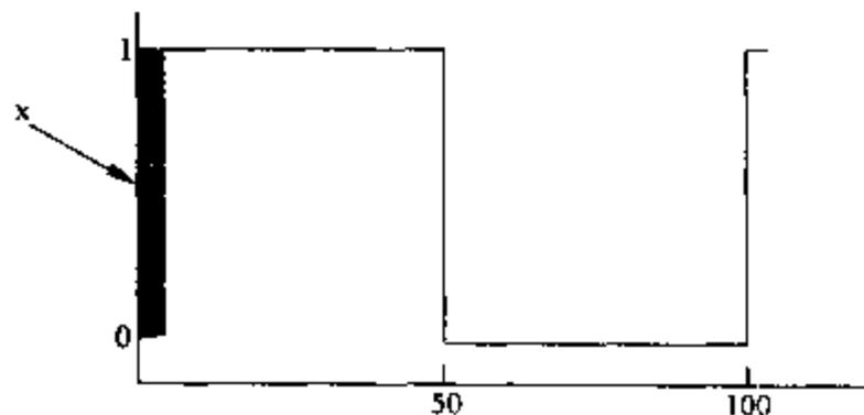
m555 模块有一个内部寄存器(clock),它也是模块的输出。在模拟开始时,输出值是 x,如该例时序图中灰色区域所示。clock 在 5 个单位时间过后被初始化为 1。m555 用一个 always 语句来进行行为建模,该 always 语句说明 clock 在 50 个单位时间后取其补值。由于一个 always 语句本质上是一个“while (TRUE)”循环,第一个 50 个单位时间过后,在另一个 50 个单位时间内调度执行 always 语句并改变它的值;即,这时时间为 100。由于 clock 每隔 50 个单位时间将改变它的数值,因此我们建立一个周期为 100 个单位时间的时钟。
