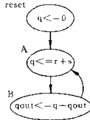
这里还有几点需要说明。如果 reset 是无效的,那么 always 块的行为将与前一节示例一样。可以通过在初始块中等待 reset 的上升沿,然后在 always 块中等待  $\sim$ reset 的方式,将复位说明为高电平有效。最后,在“wait(reset);”语句和“@(posedge clock)”语句之间不能说明任何操作。如此一来,这样一个操作将不能归入状态 B 中,因为它必须以 reset 为条件——在有限状态机的设计中通常不允许的一个操作。当 reset 成为无效时,这种动作将在另一个状态中实现,并且需要一个时钟事件,以便它显式地成为状态的一部分。因此,一个时钟事件总是写在等待无效复位值的等待语句之后。
