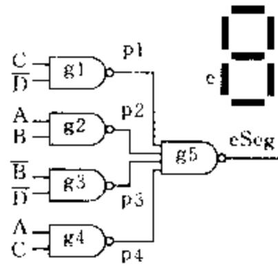
例 1.1 中也给出了这个电路的 Verilog 描述。描述表示的是一个模块的基本定义，模块名为 **binaryToESeg**。每个模块定义包括关键字 `module`，紧随其后的模块名，以及最后的 `endmodule` 语句。描述中的第二行规定在这个模块的子模块间传送逻辑值的 `wire` 的名称。第三行说明保持逻辑值的存储单元名称。这些寄存器是触发器电路元件的一个抽象。
