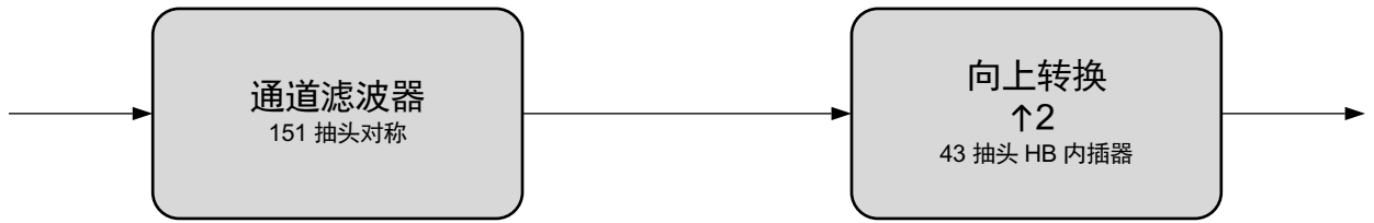
图 8：滤波器链简单示例
