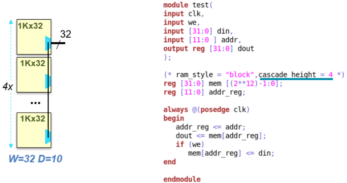
图 39：使用 1Kx32 和 CASCADE_HEIGHT=4 实现 4Kx32 的 RTL 表达式
