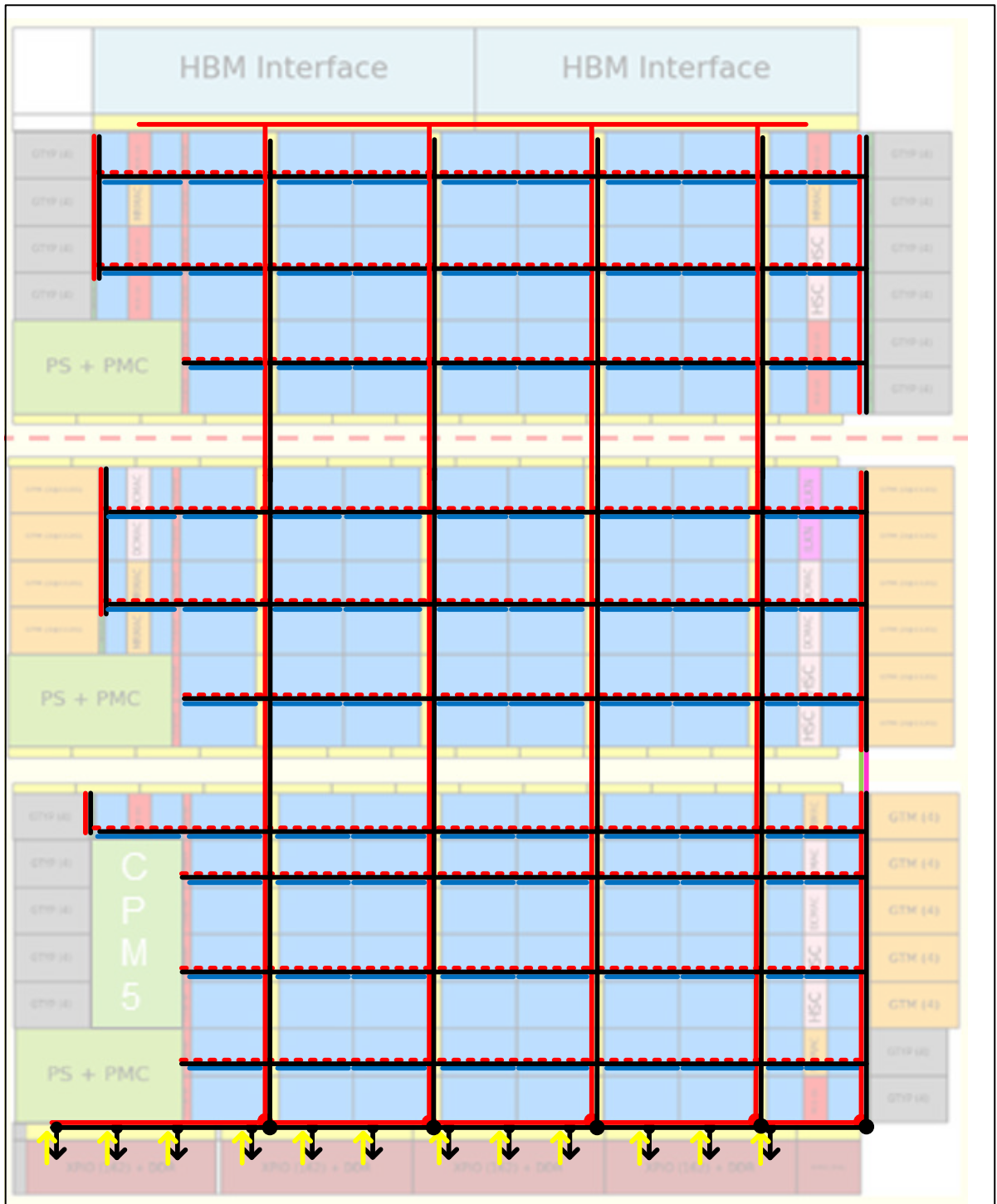
图 46: Versal 器件时钟布线架构
