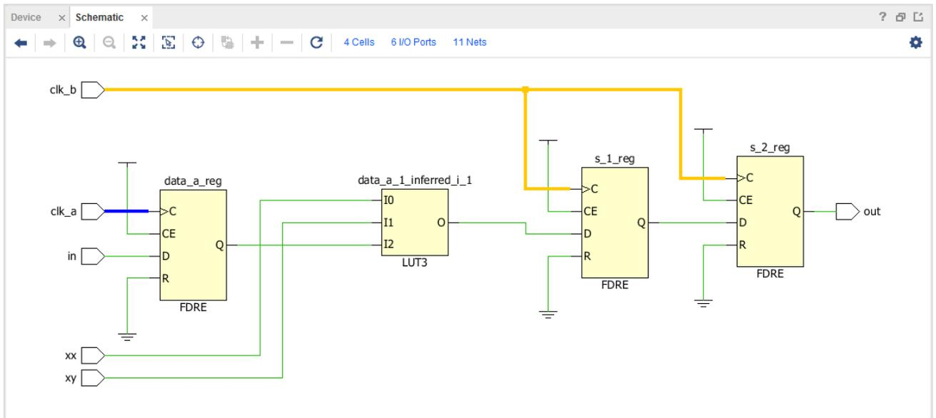
原先不推荐采用此结构，因为在组合逻辑的输出上可能出现毛刺，同步器会捕获此类毛刺并传输至设计下游其余部分。
