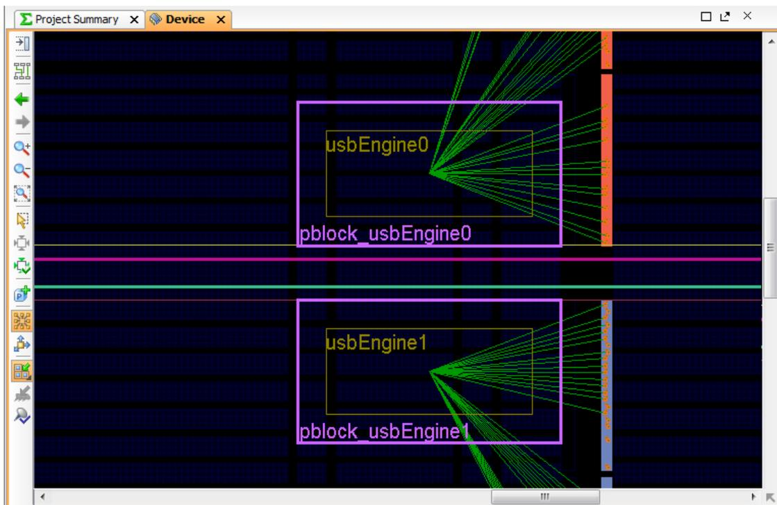
I/O 必须与相关 I/O 接口电路布局在同一个 SLR 内。为 SSI 器件布局逻辑时，也必须仔细考量时钟布局。
