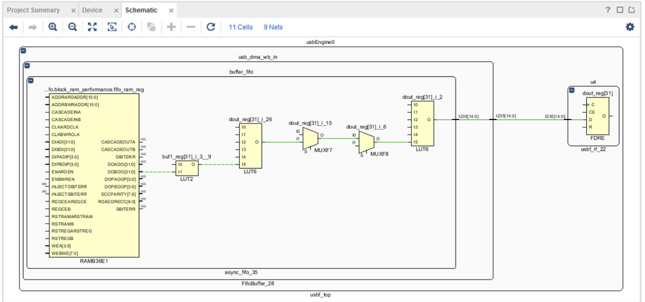
若要识别板级原理图中选定单元的相关层级分级，请从弹出菜单中选择“Select Leaf Cell Parents”（选择叶节点单元的父亲单元）。
