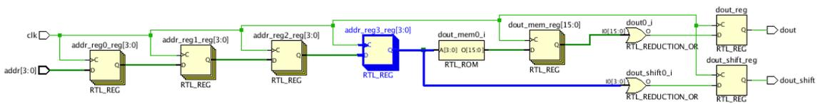
细化视图提供了有关给定测试案例结构效率低下的有效提示。在此例中，问题来自地址寄存器扇出 (addr\_reg3\_reg)，它用于驱动存储器地址和部分胶合逻辑（蓝色高亮）。
