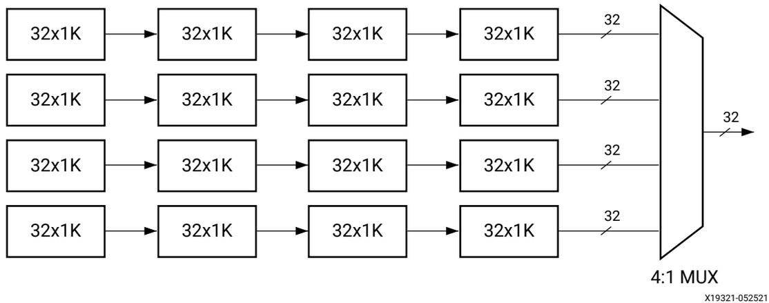
此处使用的基本原语为 32 × 1K，4 个块 RAM 通过内置功能进行级联，组成 32 × 4K 配置。4 个此类并行结构可创建 1 个深度为 16K 的存储器。输出通过多路复用生成输出数据。
