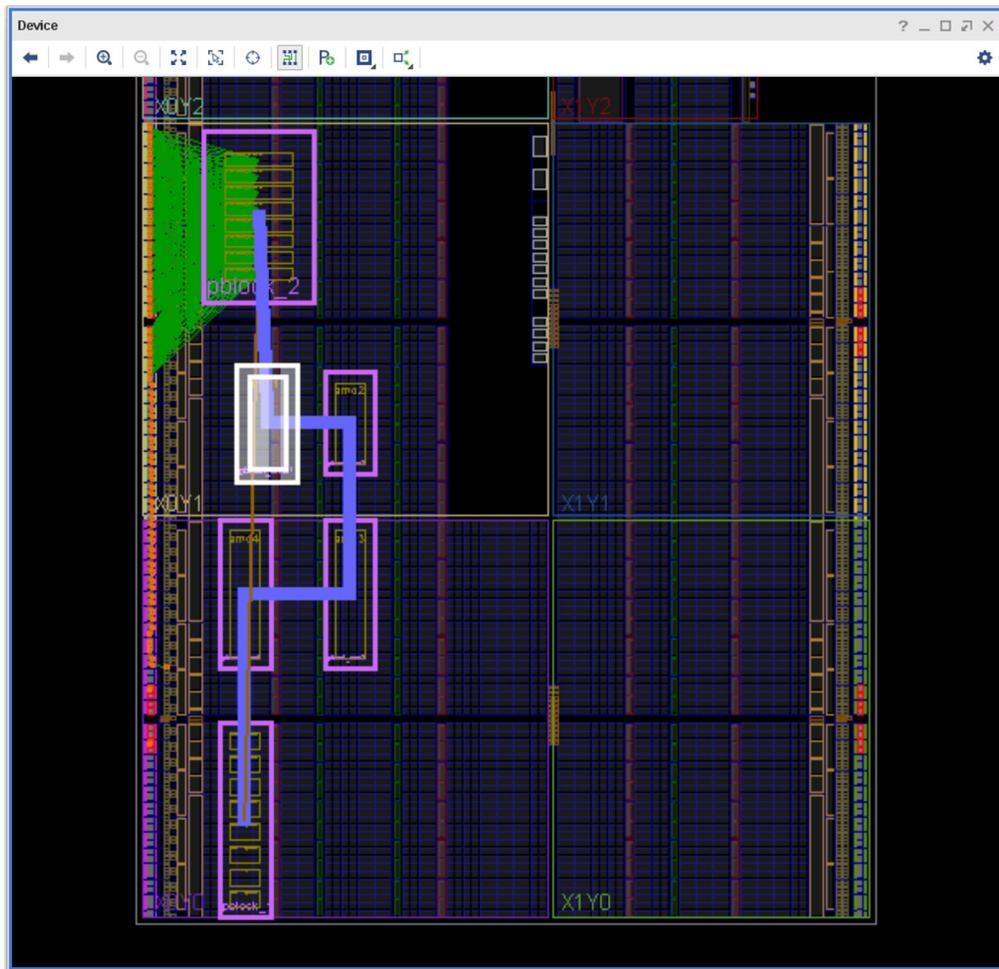
“Control Path Floorplan”（控制路径布局规划）显示的设计中的所有块都与中心块进行通信。最大的连接为中心块与最右下角的块之间的连接。中心块必须分布在整個设计周围，才能与所有其他负载进行通信。
