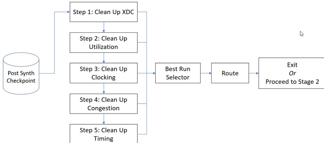
在任意给定步骤中，可以运行多条实现命令（例如，`opt_design`、`place_design` 和 `route_design`），并且可生成 QoR 建议。对于每个步骤，都有一个目标建议列表；如果在目标建议列表上出现任何生成的建议，设计就会复位到所需的设计阶段，以便成功应用该建议。如果目标建议列表上针对给定步骤没有任何建议，则会跳过此步骤。
