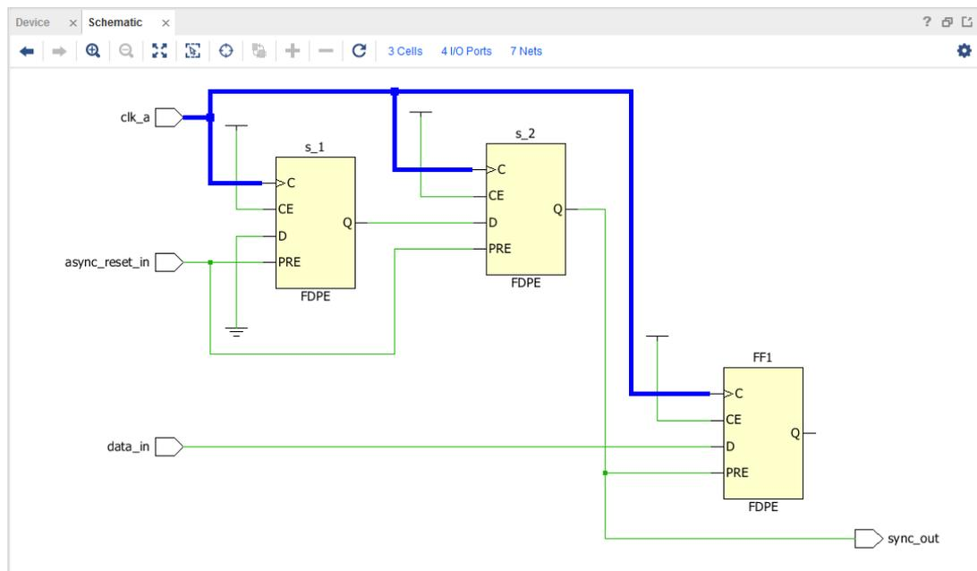
通常建议避免在目标时钟域内包含多个复位信号的同步。这意味着从源时钟域到目标时钟域的复位不应存在任何扇出。此建议可防止目标时钟域在不同时间解复位而导致设计处于未知状态。不遵循此建议会导致从发送触发器到目标时钟出现严重的 CDC-11 扇出违例。
