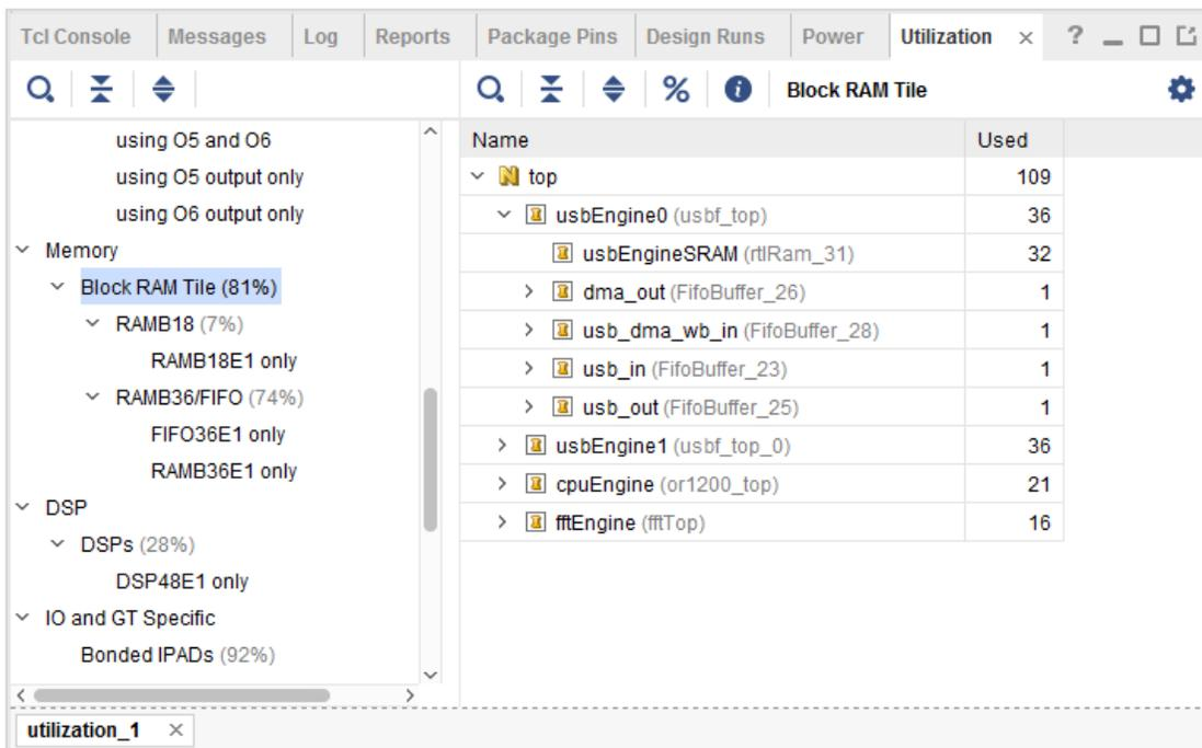
在此设计中，RAMB36 和 FIFO36 块主要供 2 个 `usbEngine` 块使用。单击“+”（加号）图标以查看子层级的使用率。
