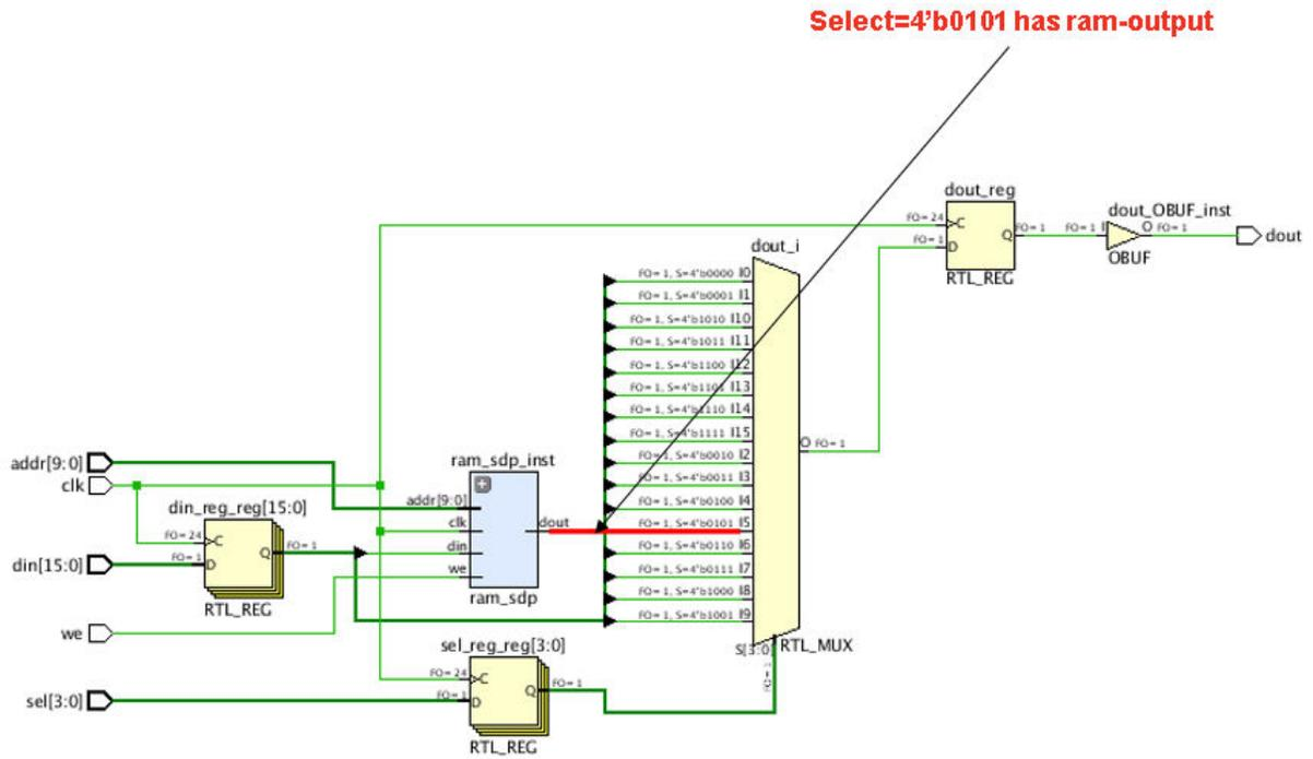
下图显示的关键路径中，以红色高亮显示块 RAM 到 FF 的路径。块 RAM->FF 和 FF->FF 都存在 2 个逻辑层次。由于块 RAM CLK->Q 延迟对于块 RAM 更高，因此 RAM->FF 为关键路径。
