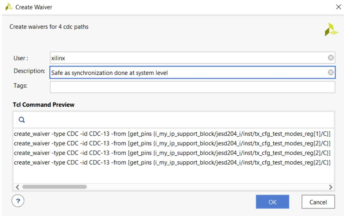
即使 Vivado 工具会填充用户名，但此“User”字段仍可编辑。“Description”（描述）为必填项，建议提供详细信息以供设计团队复查。“Tags”（标签）字段为可选字段，可用于通过关键字字符串或列表来提供额外描述。它主要用于记录，可用于搜索 XDC 文件或者使用 `get_waivers` 命令筛选豁免等。该对话框包含 GUI 发送给 Tcl 控制台的 Tcl 命令预览。
