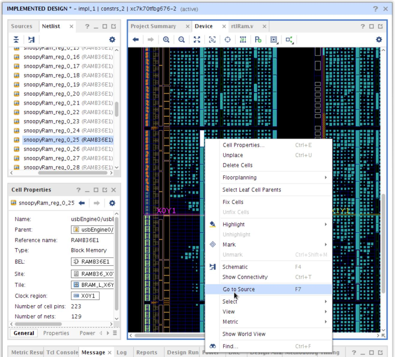
使用交叉探测判定网表门电路中涉及的源文件。由于综合变换的性质，无法对设计中每个门电路的源文件进行反向交叉探测。
