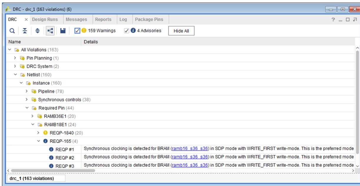
单击任一 DRC 可打开属性并显示详细消息。请查看“Properties”（属性）窗口以查看详细信息。大部分消息都包含对应于 DRC 中应用的信号线、单元和端口的超链接。
