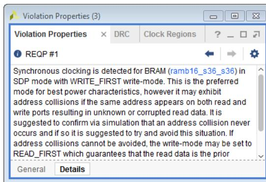
DRC 报告为静态报告。您必须重新运行 Report DRC 才能使其反映设计变更。工具判定完成某些设计操作（例如，删除对象和移动对象）后，链接已过时，并使这些链接失效。
