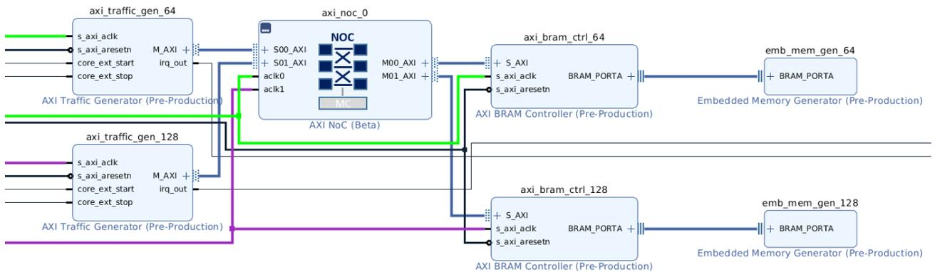
在 IP Integrator 中确认设计后的初始 NoC 解决方案如下图所示，每条 NoC 连接的布线都穿过横向 NoC。
