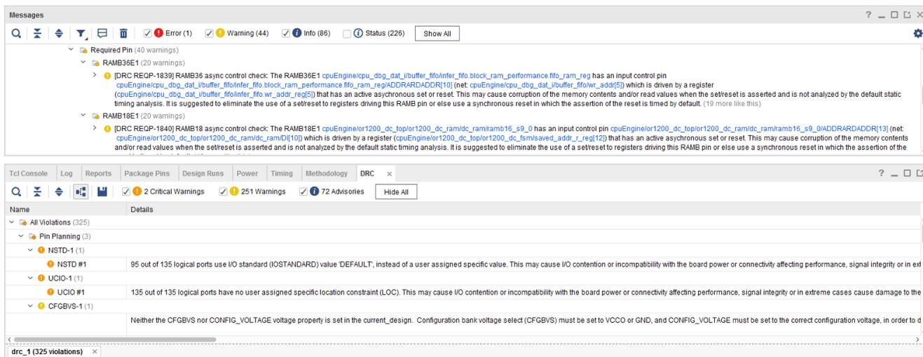
在流程初通过检查 DRC 消息、“Critical Warnings”（严重警告）和“Warnings”（警告）可防止后续出现问题。
