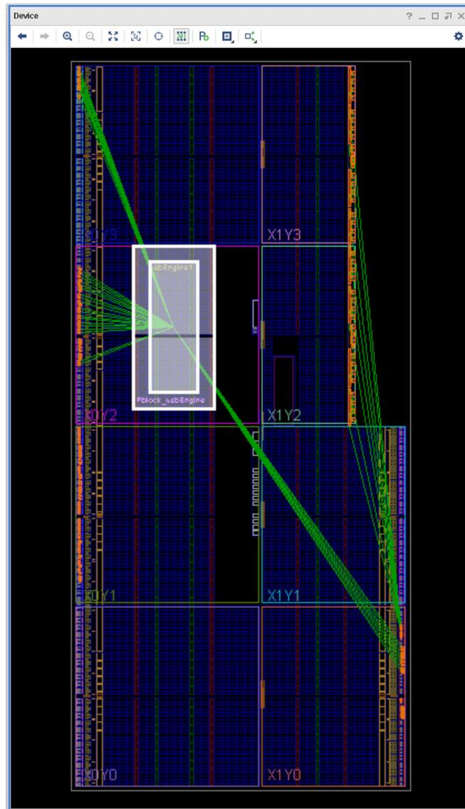
上图所示布局规划可能对时序没有帮助。请考虑将块拆分、更改源代码或者仅约束块 RAM 和 DSP。另请考虑在外部时序要求允许的情况下取消 I/O 寄存器布局。
