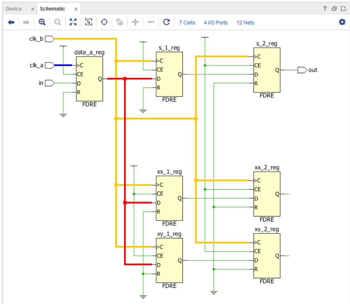
**注释：** N 到 N 个不同时钟域的扇出并不构成 CDC 问题，不会触发 CDC-11 违例。请参阅 [异步复位同步器](#) 部分，以获取复位信号上的安全扇出示例。
