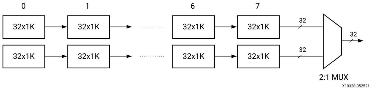
此处使用的基本原语为 32 × 1K，8 个块 RAM 通过内置功能进行级联，组成 32 × 8K 配置。2 个此类并行结构可创建 1 个深度为 16K 的存储器。输出通过多路复用来生成输出数据。多路复用器为 2:1 MUX。
