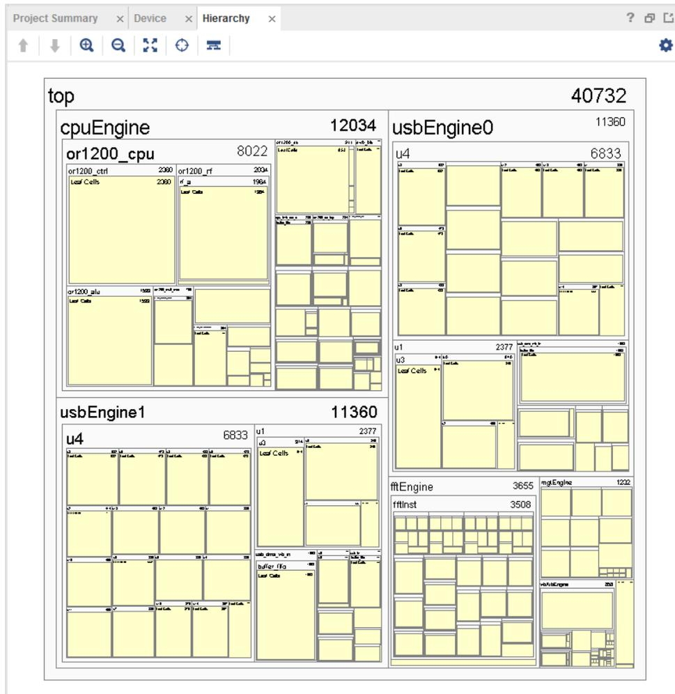
上图显示 `cpuEngine`、`usbEngine0` 和 `usbEngine1` 包含设计中的大部分逻辑，并且使用的资源数量都几乎相同。
