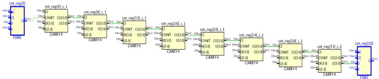
选中关键路径的起点和端点单元后，只需打开选定单元的板级原理图并展开从端点管脚返回到起点的逻辑，即可在细化视图中直观展示等效路径，如下图所示。
