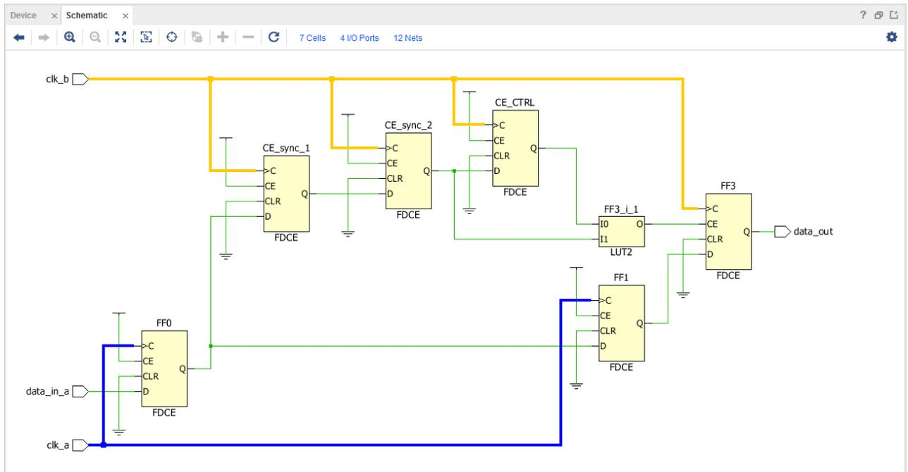
CDC 引擎仅检查连接到 FF3/CE 的信号是否同样由 `clk_b` 发送。在驱动 CE 管脚的电路上，对于时钟使能信号的同步方式不存在限制，前提是将其作为安全的 CDC 路径单独报告即可。此外，您还负责约束从 `clk_a` 域到 FF3 的时延，这通常是通过 `set_max_delay -datapath_only` 约束来完成的。
