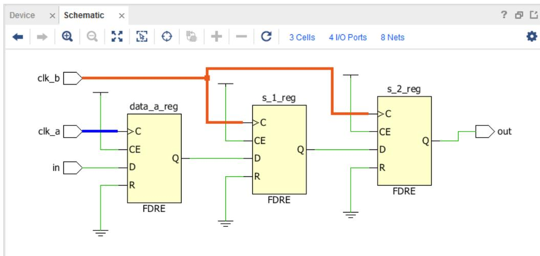
如果触发器的 CLEAR 或 PRESET 管脚同时连接到异步源，那么此同步器在报告中仅显示为单比特同步器而非异步复位同步器。
