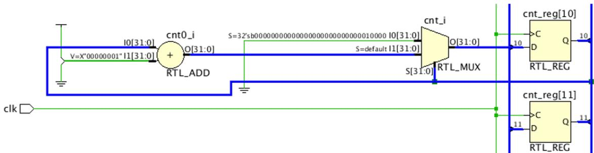
细化视图显示加法器输入大小限制为 32 位，因为信号 cnt 已声明为整数。在此特定示例中，在整个综合最优化过程中均保持使用 32 位运算符。细化视图可明示所发生的变化，您可按如下方式更改 RTL 来获得进一步优化的网表和时序 QoR。随着计数器从 0 递增至 16，您可为信号 cnt 定义范围，以强制将加法器输入宽度设置为 5 位而不是 32 位。
